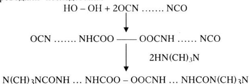
Группа -NCO с каждой стороны молекулы гарантирует желаемую стабильность отделочного агента. Препарат может храниться до одного года при любых температурах при условии отсутствия светового воздействия.
