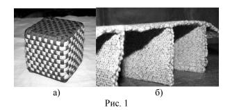
Ткачество позволяет использовать несколько разных по свойствам и составу нитей и разных ткацких переплетений в одной преформе. Более того, при ткачестве возможно изменять поперечное сечение и размер преформы в процессе изготовления путем введения или удаления нитей. Таким образом можно получить преформу с локальным распределением физико-механических свойств.
