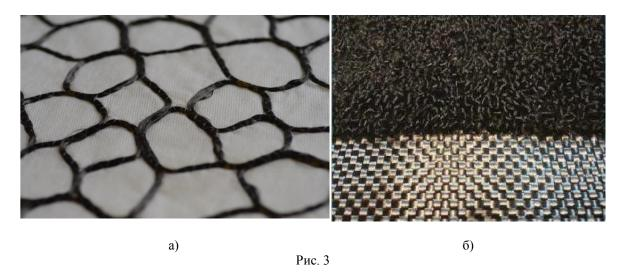
В этом случае трехмерное армирование осуществляется за счет введения в наполнитель Z-направленных нитей в заданных зонах и направлениях, что позволит повысить прочности на удар, сдвиг и расслаивание [19].
