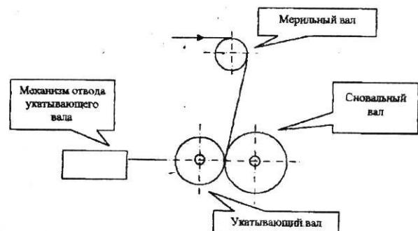
*Модернизированная сновальная машина обеспечивает формирование намотки с обратной связью. Все воспроизводимые паковки имеют одинаковые текущие и конечные длины нитей, радиусы, количество оборотов вала и структуру намотки.*
