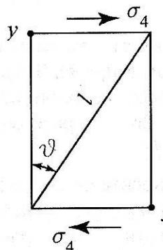
Нить подвергается сдвигу  $\gamma$  под действием касательных напряжений  $\sigma_{12}$  (в матричных обозначениях  $\sigma_4$ ). Деформирование элемента показано на рис. 1.
