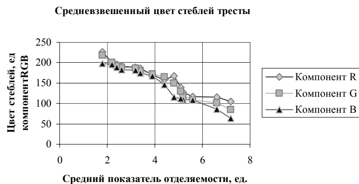
Рис. 1. Зависимость показателя отделяемости стланцевой льнотресты от ее средневзвешенного цвета по слою (модель цвета 8-бит RGB)
