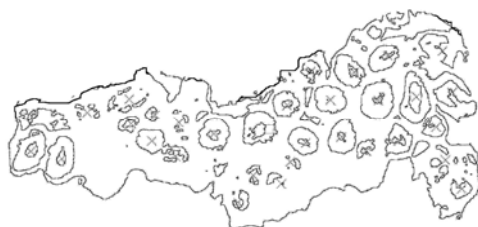
Рис.5. Поперечный срез чесаного льняного волокна Бежецкого сортоучастка.
